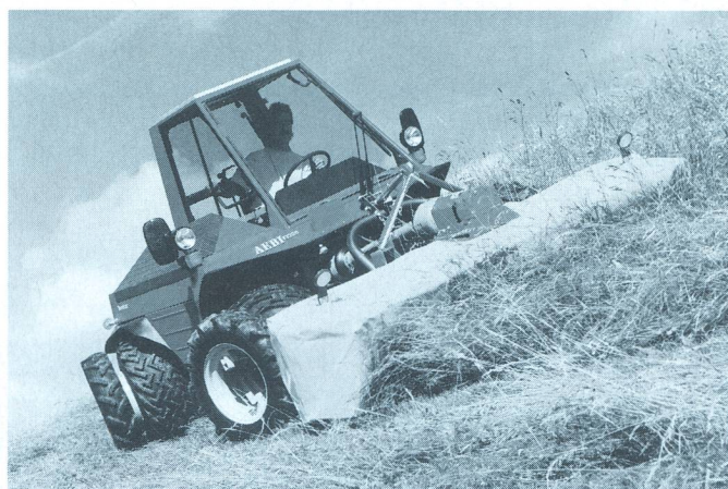
Tractor of the Year® – Millennium Edition: vainqueur de la catégorie des tracteurs spéciaux, le véhicule porte-outils (pour les pentes) Terratrak Aebi TT70S. Faucher et ménager le sol des pentes à fortes déclivités.
