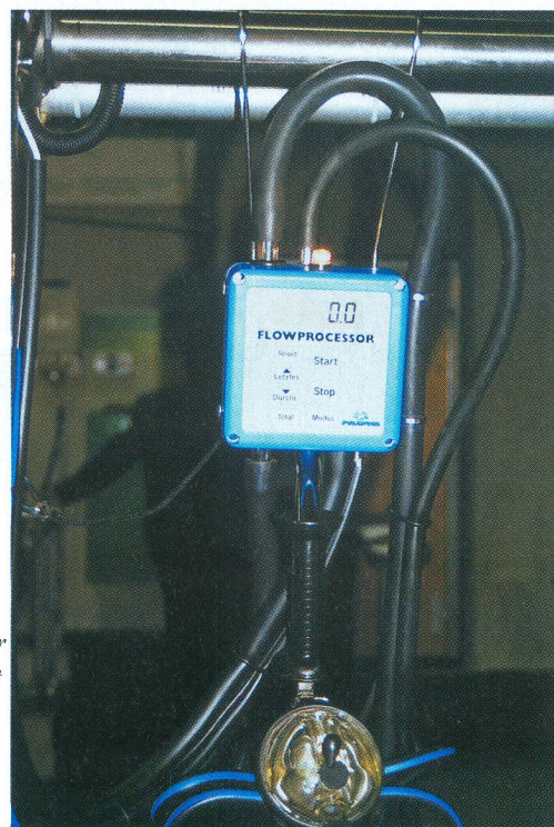
Le Flow Processor de Fullwood permet de déterminer les données quant au débit de lait individuel par vache au moyen d'un ordinateur.
