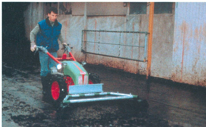
Fig. 6: Dans l'aire d'exercice extérieure, le fumier était évacué deux fois par semaine à l'aide de la motofaucheuse et d'un racleur construit à partir d'un pneu. En cas de gel, nous épandions un mélange de sciure et de paille hachée sur les zones les plus fréquentées (voies de passage).
