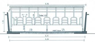
Fig. 2: Le cornadis fait d'arceaux arrondis présentait huit places d'affouragement. Il était monté sur roulettes et non fixé. En s'appuyant, les vaches poussaient le cornadis contre le tas de fourrage et avaient ainsi en permanence du fourrage à disposition.
