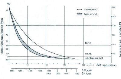
Fig. 1. Préparation de fourrages secs: courbe de séchage de cinq conditionneurs à rotors et de quatre à rouleaux en comparaison à un fourrage non conditionné.
