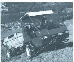
Le nouveau transporter Aebi TP 78 avec l'embrayage unique de la prise de force, un moteur de 74 CV, 3,3 l avec une augmentation du couple de 23% ainsi qu'une boîte à 26 vitesses et une grande charge utile.
