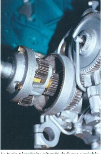
Le train planétaire répartit de façon variable la puissance entre la partie mécanique et la partie hydraulique.
