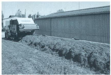
Pour le remplissage du silo-couloir, l'autochargeuse avec doseur représente la solution idéale, mais pas la meilleur marché. La bonne qualité de coupe du rotor convoyeur crée des conditions favorables à une bonne qualité de fermentation dans le silo.
