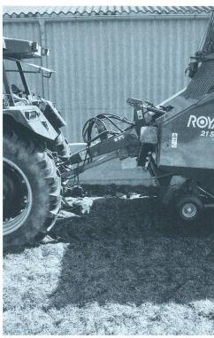
L'autochargeuse avec doseur et timon hydraulique permet d'éviter les problèmes liés au remplissage du silo-couloir.
