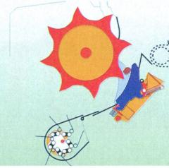
Barre de relevage quadruple à dents guidées (à gauche) et rotor convoyeur avec huit rangs de dents disposés en spirale (à droite).
