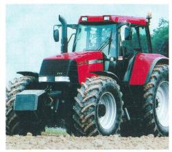
Après Fendt, c'est au tour de Case: les séries CVX et CVT entre 88 et 125 CV disposent de transmissions automatiques et d'une sonde électronique de pointe.
