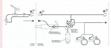
Schéma d'un frein de rupture électrique.
