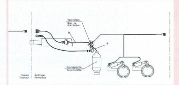
Schéma d'un frein de rupture.
