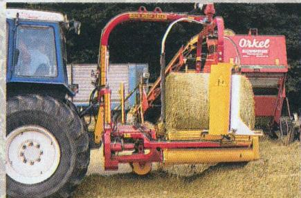
Les développements de la technique de l'ensilage en balles sont loin d'être achevés. A l'avenir, il devrait être possible de conserver du maïs d'ensilage ou des pulpes de betteraves en balles rondes. Une presse Orkel stationnaire (chargée par le haut au moyen d'un tapis roulant ou d'une souffleuse) permet de former des balles rondes en filets qui sont ensuite emballées au moyen d'une enrubanneuse conventionnelle. Les premiers essais avec des pulpes de betteraves ont donné des résultats positifs.
