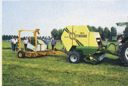
Certaines enrubanneuses sont construites de façon à ce qu'elles puissent facilement être attelées à n'importe quelle presse à balles rondes. La combinaison des deux opérations de travail (pressage et enrubannage) permet d'économiser un chauffeur et un tracteur, ce qui est très intéressant pour les entreprises agricoles, surtout en période intensive de récolte. Toutefois, ce type d'enrubanneuses ne peut pas être utilisé pour l'une des deux opérations seulement.
