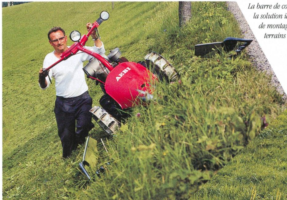
*La barre de coupe à doigts constitue la solution idéale pour les faucheuses de montagne légères adaptées aux terrains en pente.*
