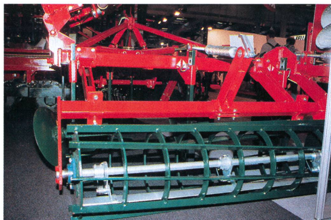
Succès et perfection du détail: Vogel & Noot ont présenté un rouleau émietteur pour travailler dans des conditions humides.
