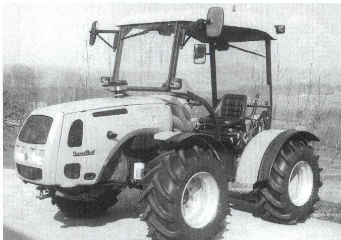
Fig. 9: Tracteur réversible LANDINI Discoveri 85, moteur turbo quatre cylindres de 59 kW (80 CV), boîte réversible synchronisée (prix catalogue: Fr. 55 800.-).
