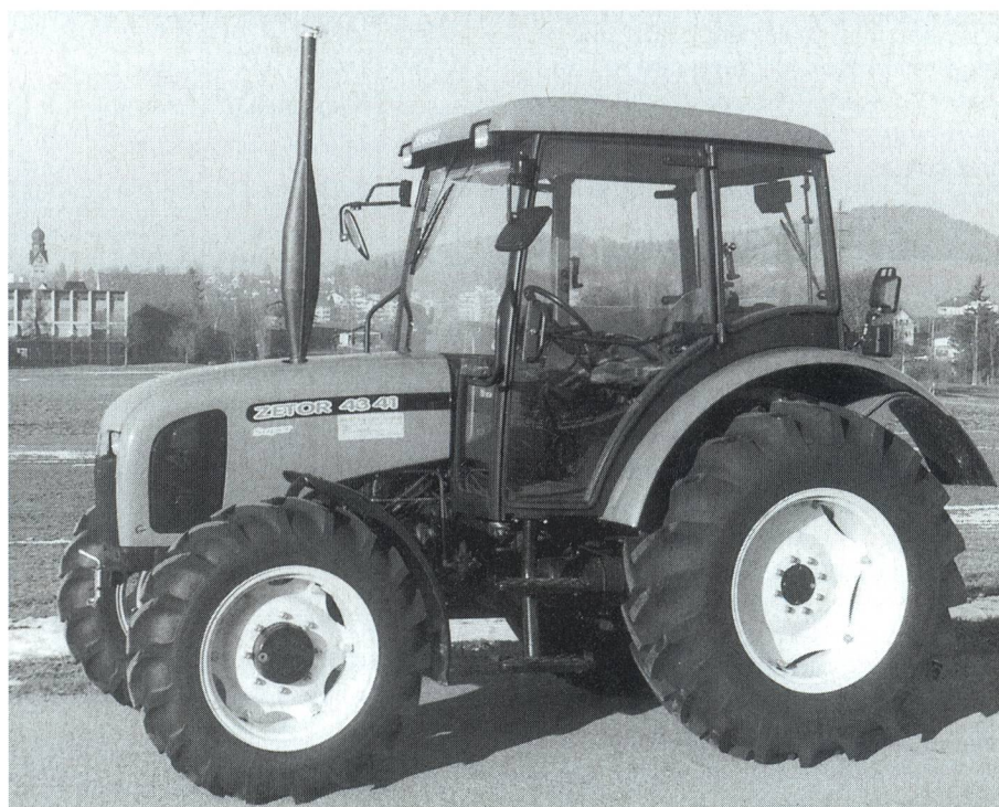
Fig. 11: Tracteur ZETOR 4341 Super, moteur d'aspiration quatre cylindres de 44 kW (60 CV), boîte de vitesses à 5 rapports partiellement synchronisée (prix catalogue: Fr. 55 806.-).
