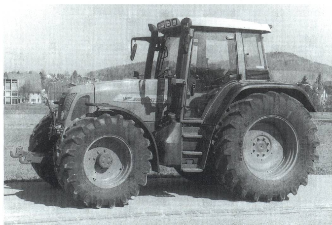
Fig. 5: Tracteur FENDT Favorit 716 Vario, moteur turbo six cylindres de 118 kW (160 CV), boîte de vitesses en continu, système hydraulique frontal (prix catalogue: Fr. 172 500.-).
