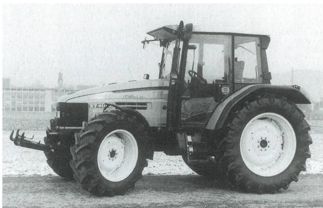
Fig. 4: Tracteur HÜRLIMANN XT 910.6, moteur d'aspiration six cylindres de 77 kW (105 CV), boîte de vitesses à passage sous charge à 3 rapports (prix catalogue: Fr. 93 500.-), système hydraulique et prise de force frontaux (supplément de prix: Fr. 7800.-).
