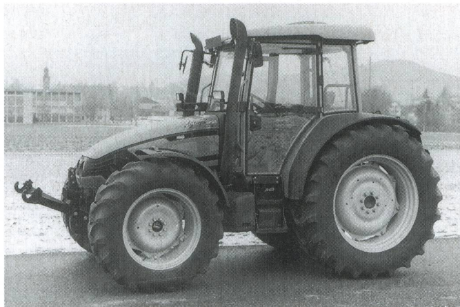
Fig. 8: Tracteur DEUTZ-FAHR Agroplus 95, moteur turbo quatre cylindres de 70 kW (95 CV), boîte de vitesses à passage sous charge à 3 rapports, système hydraulique et prise de force frontaux (prix catalogue: Fr. 90 300.-).
