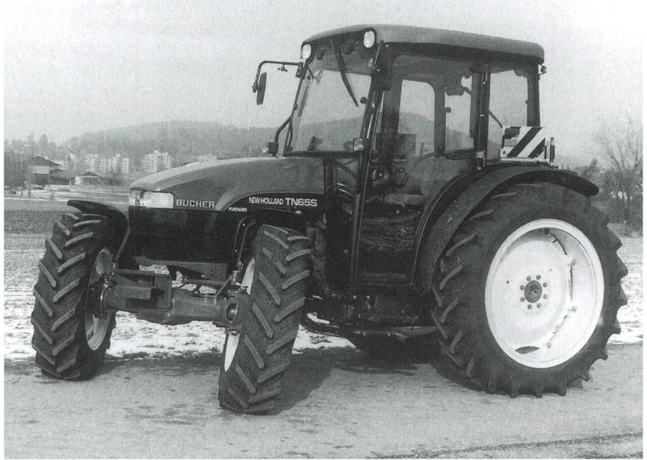
Fig. 2: L'essieu avant SuperSteer permet d'accroître l'angle de braquage de 55 à 76°. Le rayon de braquage se réduit de 7,9 à 6,8 m.
