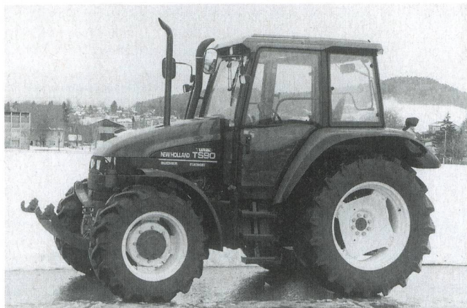
Fig. 7: Tracteur NEW HOLLAND TS 90, moteur turbo quatre cylindres de 70 kW (95 CV), boîte de vitesses à passage sous charge à 4 rapports, système hydraulique et prise de force frontaux (prix catalogue: Fr. 97 560.-).
