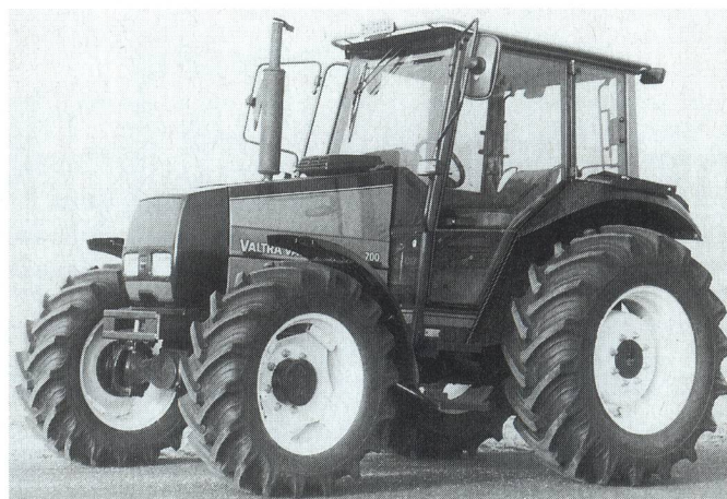
Fig. 6: Tracteur VALMET 700-4, moteur turbo trois cylindres de 51 kW (70 CV), boîte de vitesses synchronisée à 4 rapports (prix catalogue: Fr. 54 000.-).
