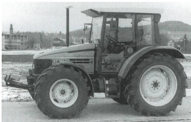
Fig. 3: Tracteur HÜRLIMANN XT 910.4, moteur turbo quatre cylindres de 76 kW (103 CV), boîte de vitesses à passage sous charge à 3 rapports (prix catalogue: Fr. 86 500.-), système hydraulique et prise de force frontaux (supplément de prix: Fr. 7800.-).
