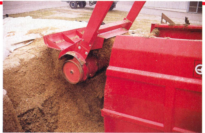
Des quantités très élevées d'ensilage peuvent être reprises au moyen de la mélangeuse: l'on compte environ 200 kg par minute, sans difficulté. Le temps que nécessitent les activités accessoires telles l'ouverture du silo, le rangement, le nettoyage n'est pas à négliger.
