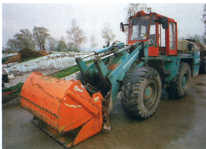
④ Dans les exploitations laitières du sud de l'Allemagne, les trax à pneus sont très répandus. Ils servent au remplissage des silos-tranchées, à la reprise de l'ensilage avec la pince à silo et à l'alimentation de la remorque mélangeuse avec de l'ensilage et autres fourrages (par exemple mélange de céréales en vrac).
