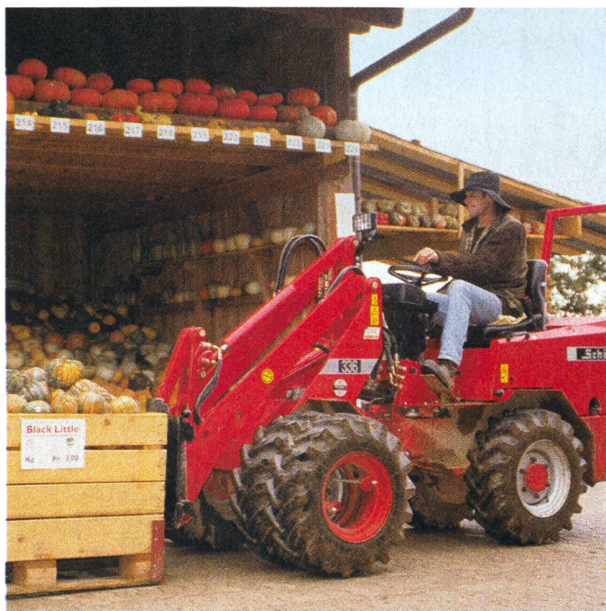
② Chargeur polyvalent muni d'un dispositif de levage télescopique permettant d'atteindre 4 m et davantage.
