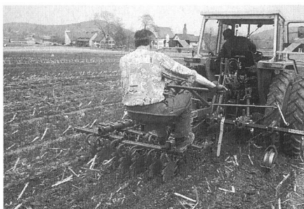
Fig. 11: Les sarcluses déracinent les adventices et les hachent efficacement. Les sarcluses-étoiles (à gauche) ne connaissent pas les bourrages mais exigent des rangées plus espacées que les sarcluses à socs en pattes d'oie (à droite).
