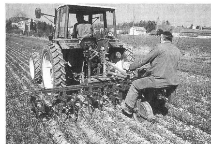
Fig. 11: Les sarcluses déracinent les adventices et les hachent efficacement. Les sarcluses-étoiles (à gauche) ne connaissent pas les bourrages mais exigent des rangées plus espacées que les sarcluses à socs en pattes d'oie (à droite).
