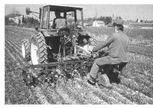
Fig. 11: Les sarcleuses déracinent les adventices et les hachent efficacement. Les sarcleuses-étoiles (à gauche) ne connaissent pas les bourrages mais exigent des rangées plus espacées que les sarcleuses à socs en pattes d'oie (à droite).
