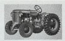
Traktor Bührer, Mod. BD-3, mit 3 Zylinder-Dieselmotor.
