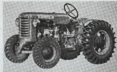
Traktor Bührer, Mod. BD-3, mit 3 Zylinder-Dieselmotor. Typischer Vertreter eines Schweizer Dieseltaktors.
