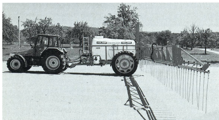
Pulvérisateur tracté Holder avec système intégré prévu à la fumure liquide.
