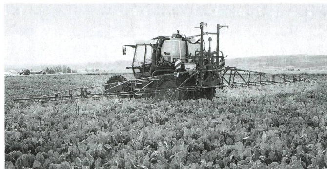
Pulvérisateur porté pour véhicules spéciaux comme Fendt GT, Xylon, JCB Fastrac et Claas Xerion.
