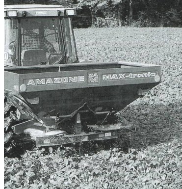
Amazone: traitement de précision avec application spécifique selon la surface par carte magnétique et DGPS.
