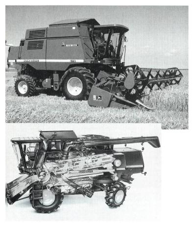
Dorénavant, la production des moissonneuses-batteuses CTS pour le marché européen se fait à Zweibrücken. CTS (Cylinder Tine Separator) est un système éprouvé depuis plusieurs années dans le monde entier.
