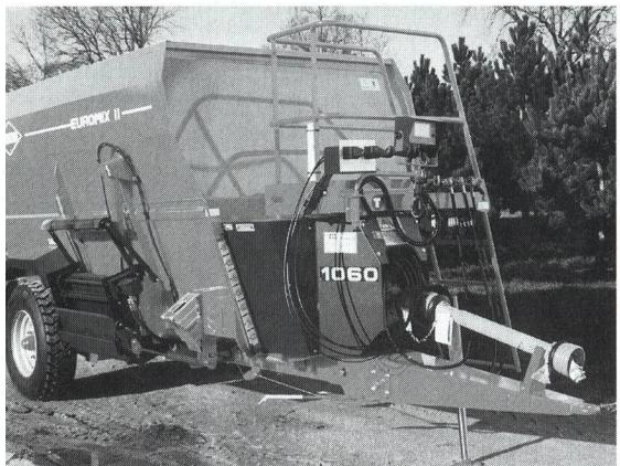
*La nouvelle programmation de pesage permet la calcul de 15 rations avec un maximum de 15 composantes. Sur toutes les mélangeuses KUHN, un châssis indépendant permet d'atteindre une grande exactitude des pesées.*
