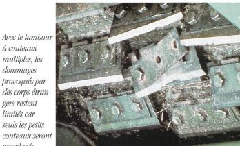
à couteaux multiples, les dommages provoqués par des corps étrangers restent limités car seuls les petits couteaux seront remplacés.
