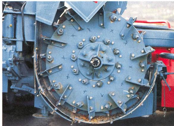
Avec le tambour à couteaux multiples, les dommages provoqués par des corps étrangers restent limités car seuls les petits couteaux seront remplacés.
