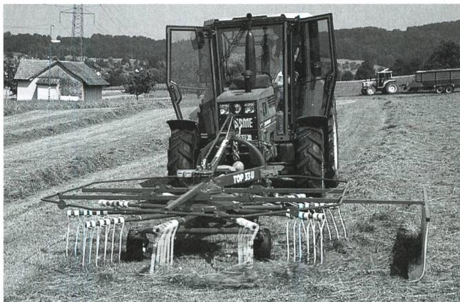
*Andaineur rotatif à l'avant: pas de passage sur le fourrage. De plus, la visibilité est excellente pour le conducteur. Pour le transport sur route, l'appareil doit être attelé à l'hydraulique arrière.*
