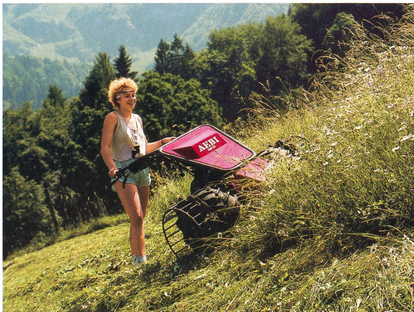
Engins à conduite pivotante: adaptés aux terrains en pente, performants et économiques.
