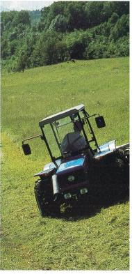
Engins à conduite pivotante: adaptés aux terrains en pente, performants et économiques.
