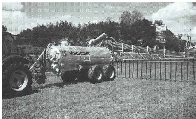
Rampe d'épandage montée sur citerne. A ne recommander que sur des sols suffisamment stables.
