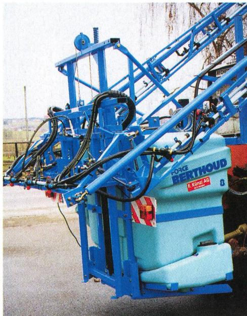
Les tronçons de la rampe sont enclenchés manuellement ou par système électrique. Le pliage de la rampe est soit mécanique, soit hydraulique. A la rampe, il est possible de monter des supports à 4 buses; il est aussi possible d'obtenir des buses à injection d'air et des buses pour engrais liquide.
