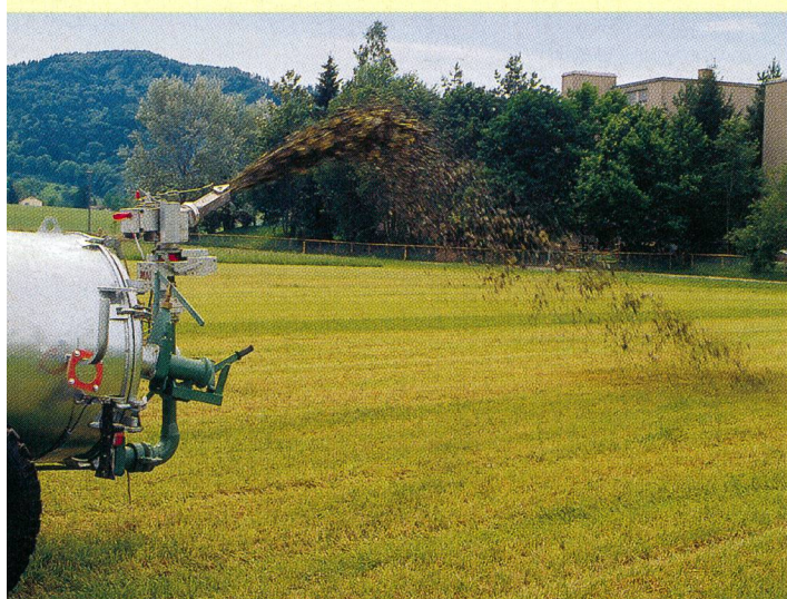
En raison de la vision insuffisante sur le distributeur, son réglage depuis le siège du tracteur n'est pas simple. Cela pourrait constituer une des raisons pour lesquelles ce système n'est pas encore très répandu.
