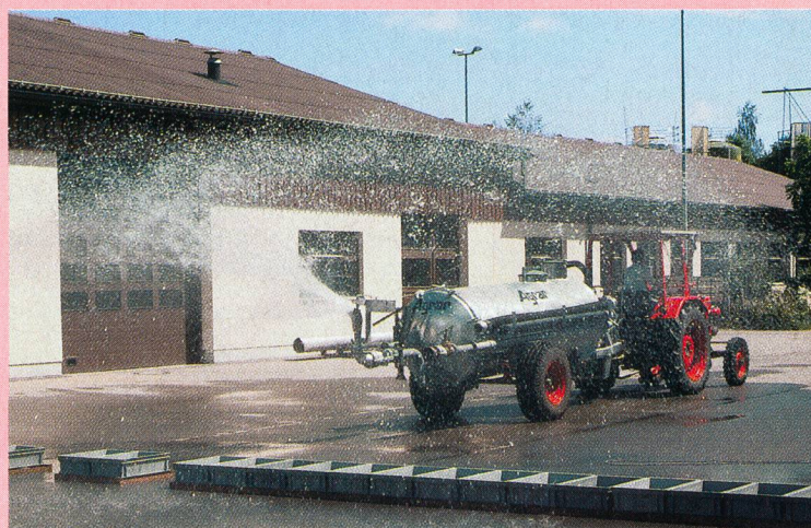
Banc d'essai servant à mesurer la répartition latérale avec récipient de récolte (40 x 60 cm).
