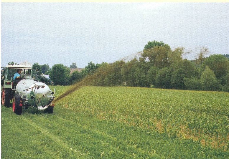
Les distributeurs latéraux se rencontrent surtout pour l'épandage latéral de champs de maïs ou d'endroits peu accessibles. La précision de distribution s'avère insuffisante.
