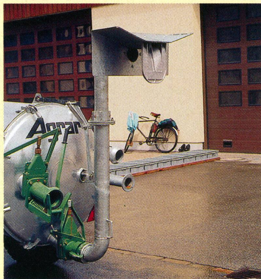
Distributeur vertical par le haut avec conduite. Une conduite télescopique permet le réglage de la hauteur et ainsi le choix de la largeur de travail.
