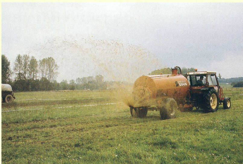
Avec les déflecteurs pour l'épandage de longue portée, la précision de distribution se voit fortement influencée, même en cas de léger vent.
