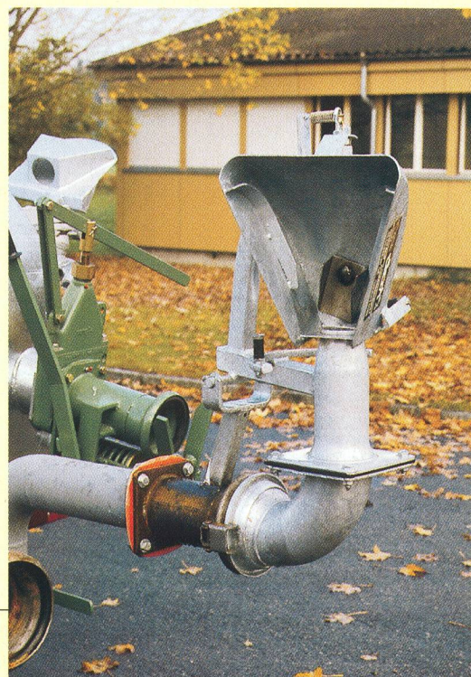
Les distributeurs verticaux ont l'avantage, par rapport aux déflecteurs conventionnels, de permettre une distribution plus précise aux deux extrémités du champ.
