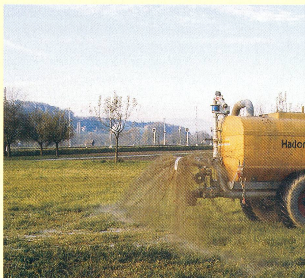
Les distributeurs verticaux ont l'avantage, par rapport aux déflecteurs conventionnels, de permettre une distribution plus précise aux deux extrémités du champ.
