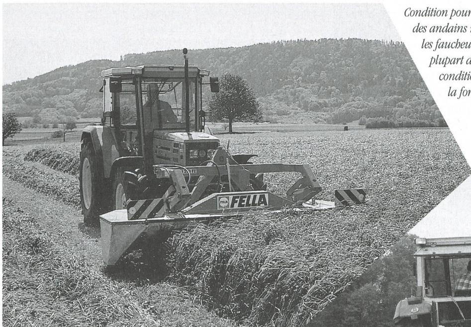
Condition pour le fauchage frontal: obtenir des andains nets et bien formés. Ainsi, les faucheuses portées à l'avant sont la plupart du temps équipées d'un conditionneur intégré qui renforce la formation de l'andain.
