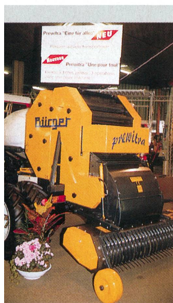
En montagne, trois travaux pour un passage: le Prewitra de Bürger presse, enrubanne et transporte les balles.
