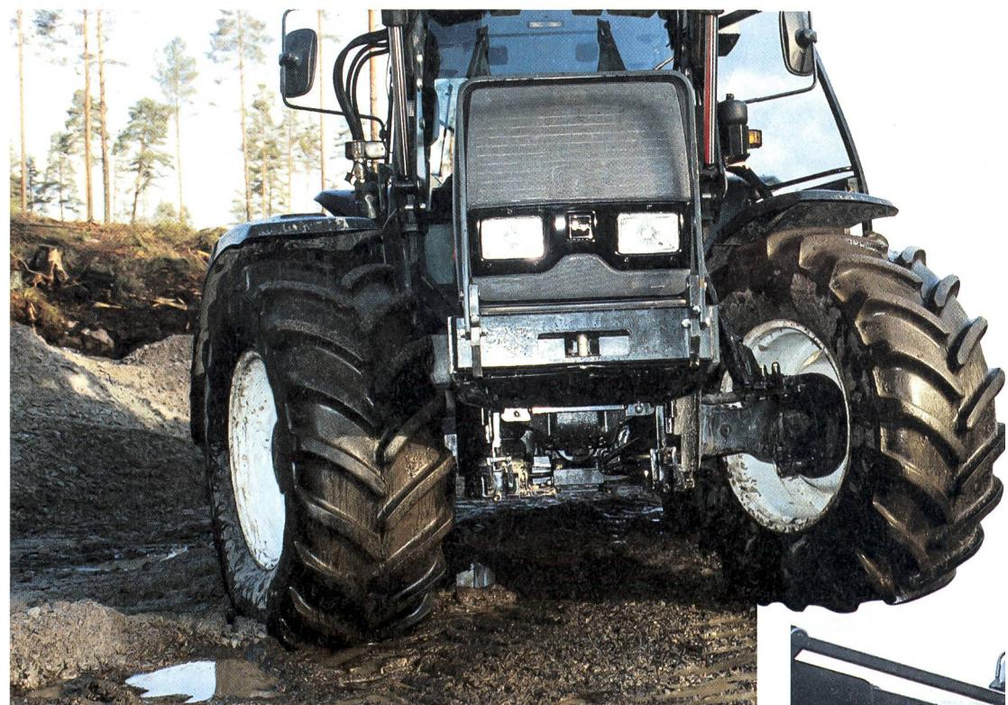
*Le pont avant à suspension pneumatique est monté sur les tracteurs 6 cylindres; le pont avant pivote autour de deux articulations placées en position arrière et est amorti par deux boudins à air placés à l'avant.*
