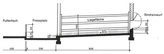
Le système de couche en pente est approprié pour l'engraissement et les vaches laitières. Il s'agit ici d'une coupe à travers un box d'engraissement de taureaux. L'aire d'affouragement est délimitée par un système dit palissade. La paille fraîche est répandue depuis l'arrière de la couche au travers d'une ouverture dans la paroi (cf. rapport FAT no 346).
