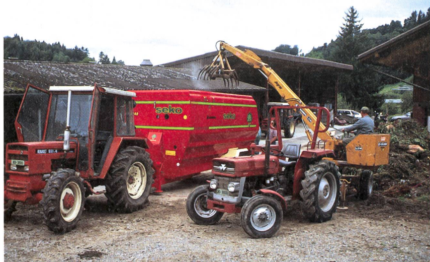
La remorque mélangeuse constitue une solution remarquable: récolte, bachage, mélange et mise en place avec la même machine.
