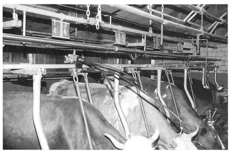
Photo 1. On a essayé sans succès de faire reculer la vache avec un moteur d'essuie-glaces et des tubes PVC élastiques intégrés.
