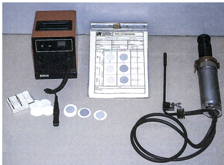
fig. 3: Les fumées noires sont le signe d'une combustion incomplète et devaient appartenir au passé, en tous cas pour les moteurs modernes. La valeur maximale – qui ne devait pas être dépassée – correspondait à 3,0 SZ (Bosch), ce qui signifie que les fumées sont à peine visibles.
