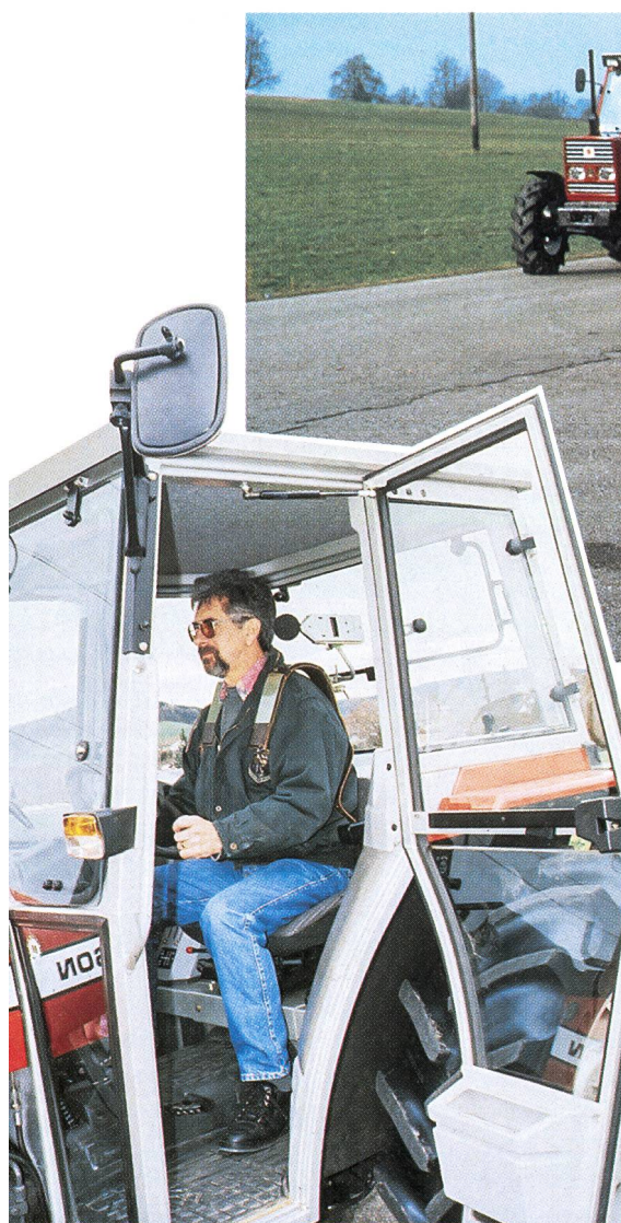
fig. 5: Les mesures du bruit de passage se font à pleine vitesse à une distance de 7,5 m. Les tracteurs agricoles sont souvent utilisés tôt le matin et tard le soir. Il est donc important qu'ils puissent traverser les quartiers d'habitation sans engendrer de nuisances excessives.
