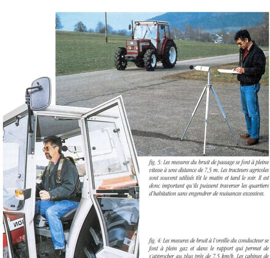
fig. 4: Les mesures de bruit à l'oreille du conducteur se font à plein gaz et dans le rapport qui permet de s'approcher au plus près de 7,5 km/h. Les cabines de sécurité modernes permettent de réduire le bruit à moins de 80 db(A). Une telle réduction du bruit s'avère très appréciée par les conducteurs.
