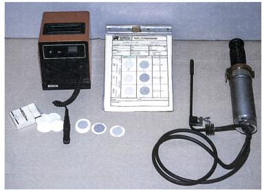
fig. 3: Les fumées noires sont le signe d'une combustion incomplète et devraient appartenir au passé, en tous cas pour les moteurs modernes. La valeur maximale – qui ne devait pas être dépassée – correspondait à 3,0 SZ (Bosch), ce qui signifie que les fumées sont à peine visibles.
