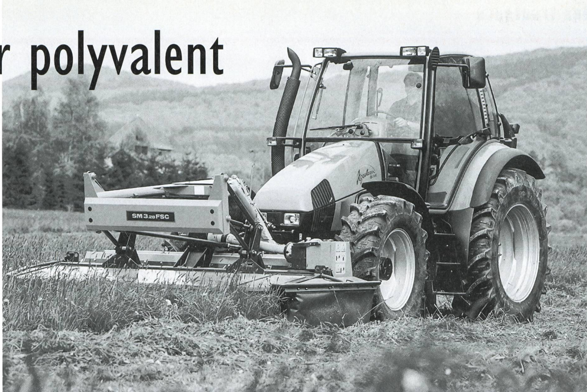
③ Amélioration de la visibilité grâce au capot plongeant (photo d'usine).
