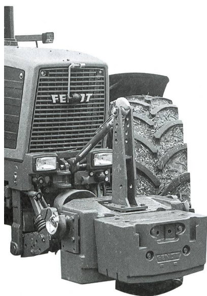
④ Contrepoids avant, avantageusement fixés à l'hydraulique.
