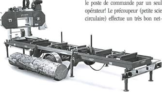
toyage du trait de scie afin de rendre inutile un écorçage de la grume. La longévité des lames est prolongée et on obtient une économie de 30 à 40% lors de l'affûtage. Etant donnée que la tête de la scie se déplace sur le bois, seule une simple longueur de bois est nécessaire.
