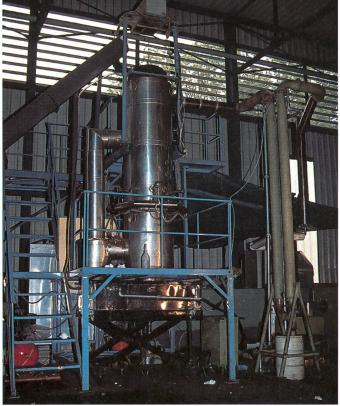
nombre en Inde et mis au point par une université, est donc acheté et ramené en Suisse afin d'y être adapté. Adjoint à un silo, il permet non seulement de transformer le bois en gaz de bonne qualité et apte à faire tourner un moteur, mais il est aussi révolutionnaire dans la mesure où le chargement peut s'effectuer en continu grâce au réacteur ouvert, au contraire des autres types de gazéificateurs actuellement disponibles sur le marché,
