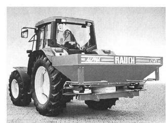
drauliques et électriques. Le spécialiste des cultures peut, grâce au contrôle de débit électronique Quantron L avec réglage indépendant de la vitesse d'avancement, doser la quantité d'enfrais de manière efficace et écologique. Aujourd'hui, les distributeurs d'enfrais Rauch remplissent les conditions de longévité et d'exactitude de demain. Pour de plus amples informations sur l'application des engrais, adressez-vous à:
