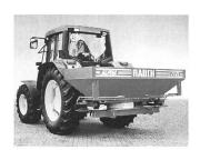
drauliques et électriques. Le spécialiste des cultures peut, grâce au contrôle de débit électronique Quantron L avec réglage indépendant de la vitesse d'avancement, doser la quantité d'engrais de manière efficace et écologique. Aujourd'hui, les distributeurs d'engrais Rauch remplissent les conditions de longévité et d'exactitude de demain. Pour de plus amples informations sur l'application des engrais, adressez vous à:
