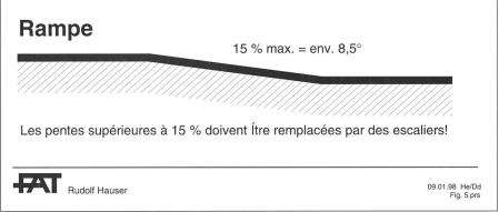
Fig. 5. La surface des escaliers et des rampes doit être antidérapante. Les marches doivent présenter une légère inclinaison vers l'extérieur. Les vaches évitent les surfaces glissantes. Pour prévenir le danger que représente le gel, il faut épandre de la sciure, du sel ou des cendres.
