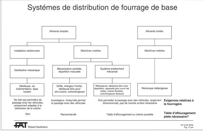
Fig. 17. La distribution de fourrage grossier sera encore plus mécanisée à l'avenir. Le schéma présente les techniques usuelles et les exigences correspondantes en matière de fourragère (d'après Pirkelmann 1990).
