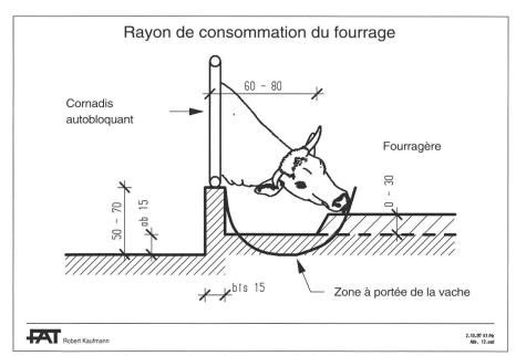
Fig. 13. Lorsqu'elle mange, la vache peut atteindre la zone marquée en pointillés. Les dimensions diverses doivent en tenir compte. Lorsque le cornadis est installé en biais par rapport à la crèche, la zone à portée de la vache s'en trouve considérablement élargie (dimensions en cm).
