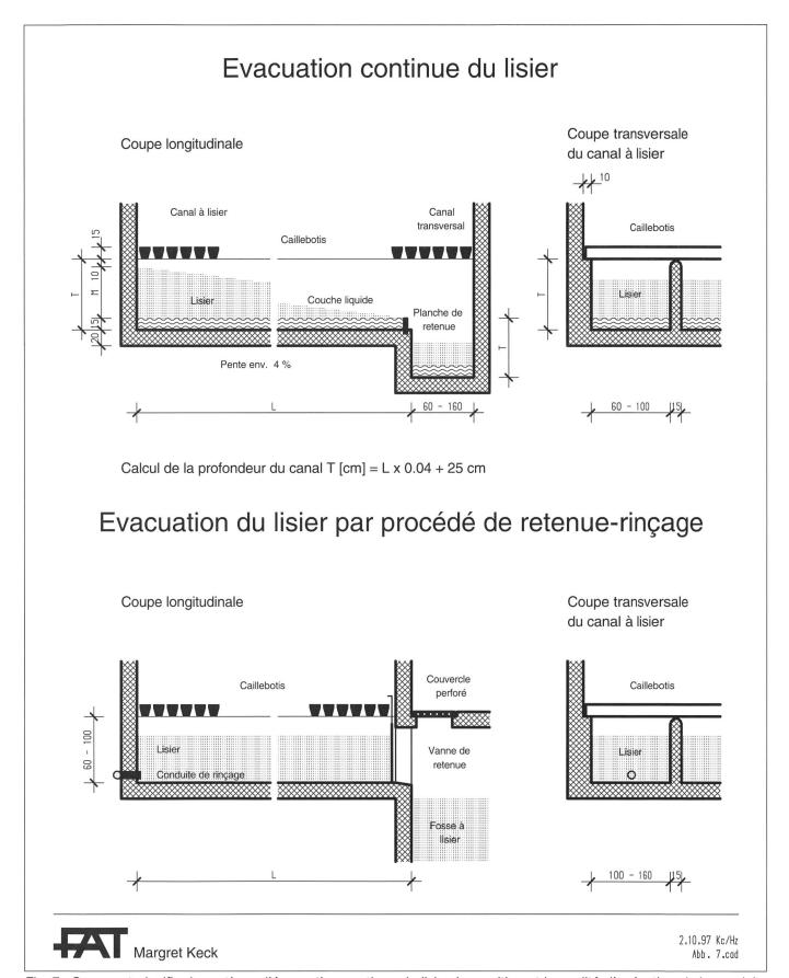
Fig. 7. Comment planifier le système d'évacuation continue du lisier. La position et la qualité d'exécution de la conduite de rinçage et de la vanne de retenue sont essentielles pour le bon fonctionnement d'évacuation du lisier par procédé de retenue-rinçage (Steiner et al. 1987) (dimension en cm).
