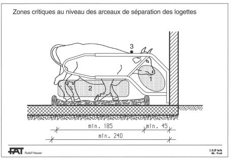
Fig. 10. 1. Lorsqu'elles se relèvent, les vaches doivent pouvoir écarter leur tête sur le côté. 2. La hauteur de la séparation latérale doit permettre aux bêtes d'étendre leurs pattes, mais également empêcher qu'elles ne passent le dos dessous. 3. La barre de nuque doit être réglée de façon à ce que l'animal ne souille pas sa couche par des excréments (dimensions en cm).
