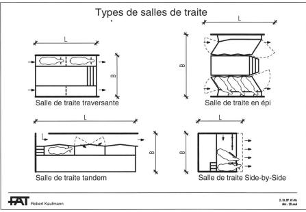
Fig. 20. Vue d'ensemble des salles de traite les plus utilisées. La salle de traite tandem permet de faire entrer et sortir les vaches individuellement. Dans les salles de traite tandem et traversante, le trayeur a la meilleure vision possible de l'animal pendant la traite. La salle de traite parallèle est un système qui exige peu de place. Enfin, avec la salle de traite en épi, on tient souvent compte d'un agrandissement ultérieur de la salle de traite (L= longueur, B = largeur; voir tab. 3).
