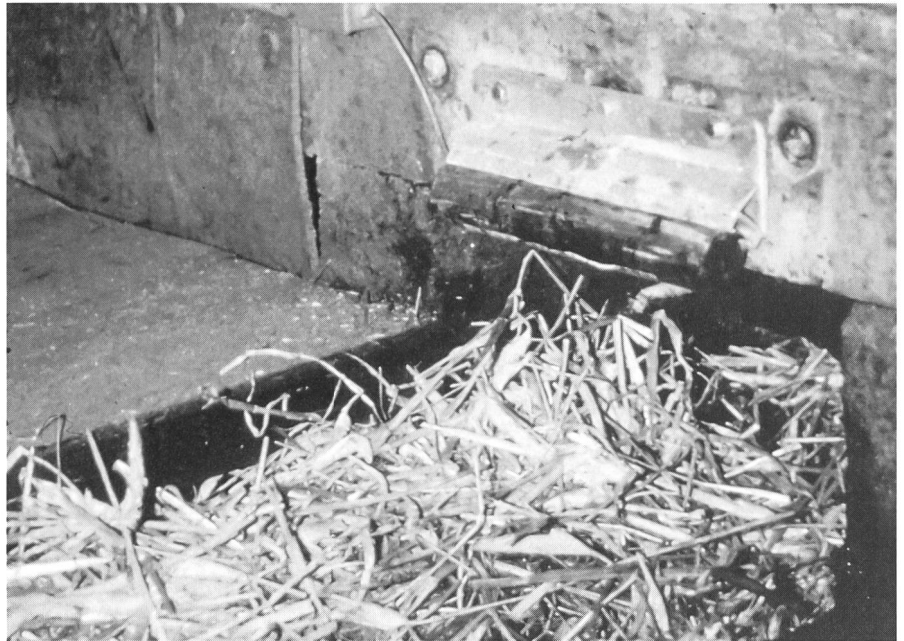
Fig. 8. Si les distances de sécurité ne peuvent pas être respectées dans les systèmes d'évacuation, il faut installer des lices de contact aux endroits dangereux.
