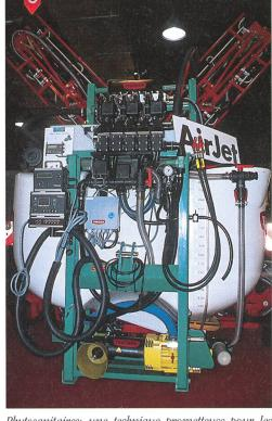
Phytosanitaires: une technique prometteuse pour les appareils. Un ordinateur de bord surveille l'induction de l'air et le débit afin d'assurer une taille constante des gouttelettes, même en cas de variation de vitesse.
