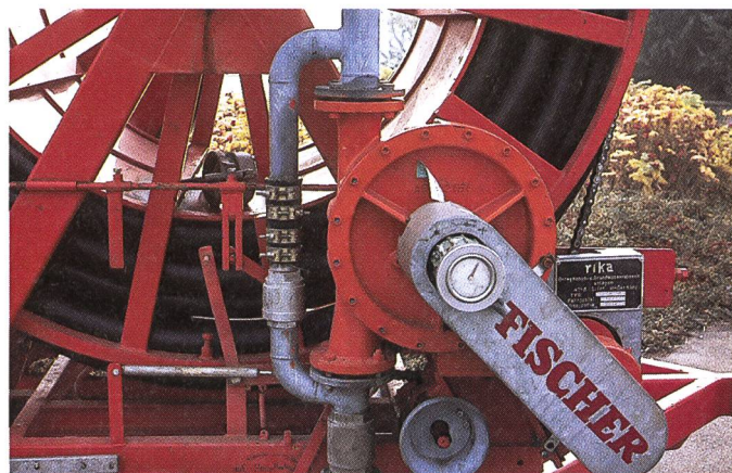
La turbine est le plus répandu parmi les différents types d'entraînement. Une conduite by-pass sert à la commande du tambour d'enroulement. La prise de force sous la turbine permet l'utilisation simple du tracteur.
