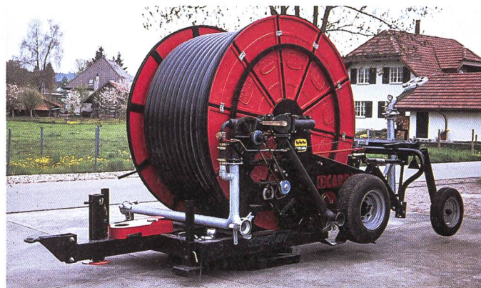
Les gros asperseurs sont également disponibles avec un châssis se rabaisant, ce qui permet de diminuer la hauteur de la machine.
