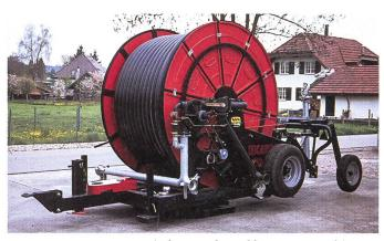
Les gros asperseurs sont également disponibles avec un châssis se rabaissant, ce qui permet de diminuer la hauteur de la machine.
