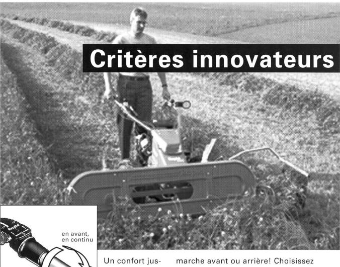
ment compact de la barre de coupe du Rapid Euro-Compact garantit une adaptation plus précise au sol, une force de soulèvement réduite et une maniabilité plus élevée. Sécurité en main grâce à la poignée tournante: inutile d'embrayer ou de freiner. Réglage progressif de la
