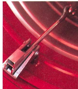
*Un système de verrouillage facilite le montage des roues jumelées avec l'écrou à calotte, l'entretoise et la clef à tube. (Photos: Ueli Zweifel)*
