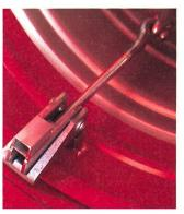
Un système de verouillage facilite le montage des roues jumelées avec l'écrou à calotte, l'entretoise et la clef à tube. (Photos: Ueli Zweifel)
