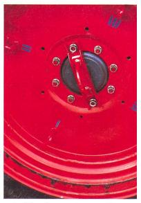
Grâce à l'attelage rapide AW-Quick, les roues peuvent être accouplées pour divers usages: roues larges et étroites, roue de même taille ou roues à double sillon.
