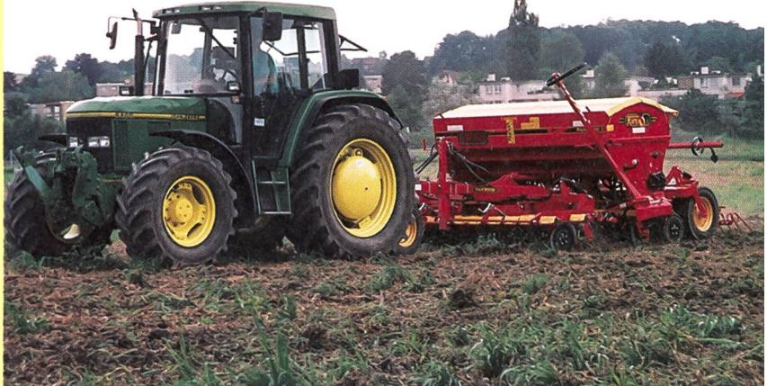
Les machines de semis direct plus légères offrent un compromis entre les machines lourdes et le semis conventionnel. Elles permettent de semer après un travail du sol superficiel avec un cultivateur, une bêche à disques, à bêches roulantes ou après une préparation conventionnelle du sol (Photo: Agritec Griesser SA).
