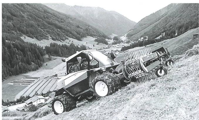
Le moteur Perkins robuste convainc par son grand rendement, sa vigueur et son élasticité. L'injection directe à deux niveaux réduit le bruit du moteur et l'utilisation de carburant. Les essieux «portiques» permettent une adhérence au sol, une aptitude tout-terrains par un positionnement bas du centre de gravité. Ils garantissent un ramassage qui ménage même les hauts andins.
