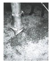
Tuyau d'aspiration dans un silo de mais: pas de mécanisation extrême mais un allégement sensible du travail et un gain de temps appréciable.
