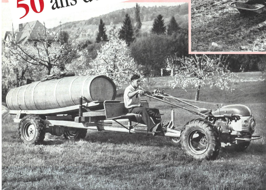
1947: Le monoaxe Bucher KT 10 sortait d'usine équipé d'une prise de force entraînant l'axe de la remorque.
