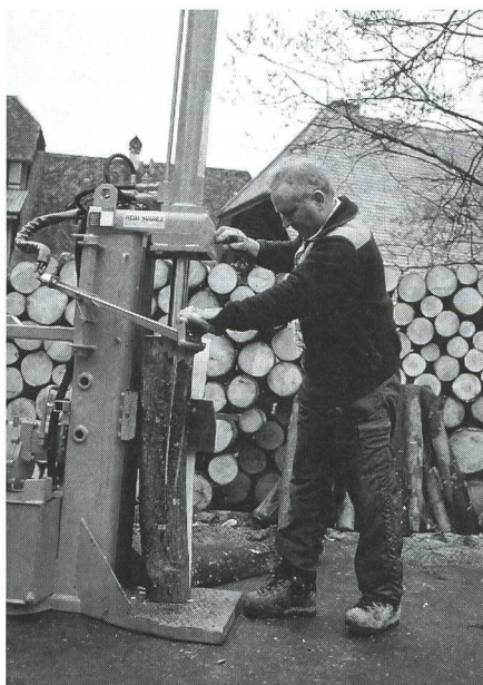
Il faut s'habituer à la commande bimanuelle. Important: un bras mobile guide la pièce de bois qui est maintenue par le haut.
