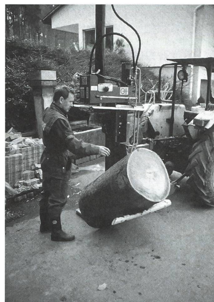
Une installation hydraulique qui sert à disposer sans peine les lourdes pièces de bois sur la fendeuse.
