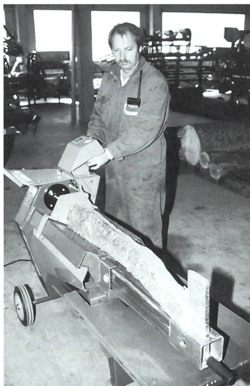
Fendeuse horizontale avec plaque de poussée mobile et couteau-fendeur rétractable à droite pour le façonnage de bois de différentes longueurs. (photos U. Zweifel)
