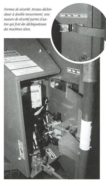
Un dispositif de régulation électronique garantit un flux de matériau régulier.
