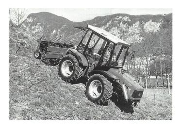
Le nouveau tracteur réversible Vanguard MT800 de BCS, du fabricant italien, est de top niveau! Ce tracteur cache la technique de demain: il est composé d'un moteur VM de 70 CV, à 4 cylindres avec injection directe. Cela permet d'économiser jusqu'à 30% de carburant, d'obtenir une force de
